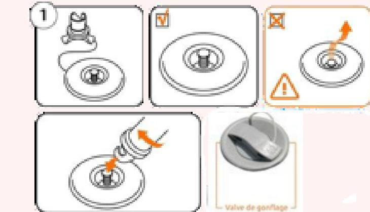
En phase de dégonflage, le bouton poussoir doit être placé vers le bas.
